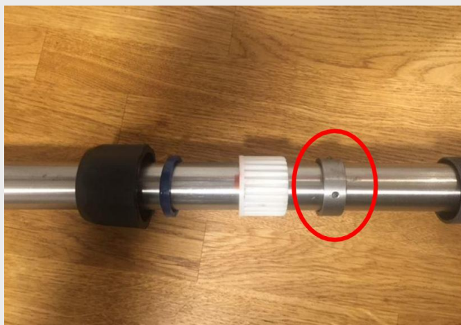
Det mekaniska stoppet syns när armen dras ut – markerat med röd ring i originalbild
