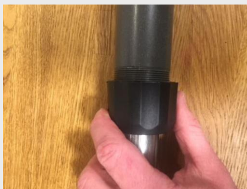
Plasthylsan skruvas bort – lossas med handkraft eller skiftnyckel
