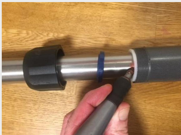
Strecket ritas vid den vita plasthylsan som referens för stoppläget
