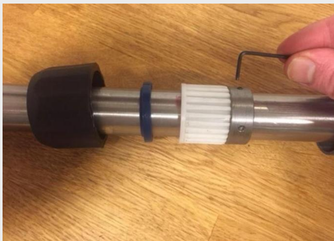
Stoppet placerat mot vita plastylsan och skruvas fast med insexnyckel
