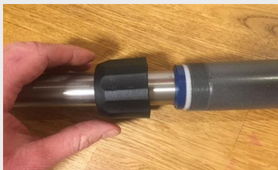
Blå tätningring placeras mot vita plastylsan
