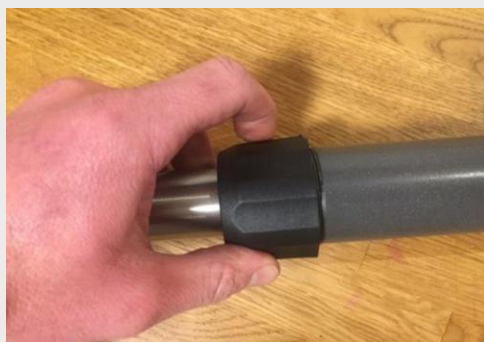
Plastylsan skruvas fast igen
